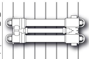
Quindi, segnare le scanalature superiori e inferiori di ciascuna piastra di montaggio. Utilizzare i sei fissaggi per montare l'unità e verificare che la rondella sia posizionata fra la testa della vite e la piastra di plastica.
