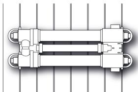
**Cuidado:** para evitar que este equipamento caia à água, não o instale acima ou junto das paredes do tanque. Não ligue o equipamento à corrente eléctrica até este estar bem fixo e até ter todos os tubos ligados.
