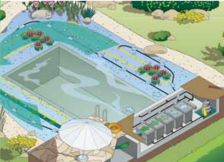
Schematische Darstellung: Modulfilter ProfiClear eignen sich hervorragend für den Einsatz an Schwimmteichen
